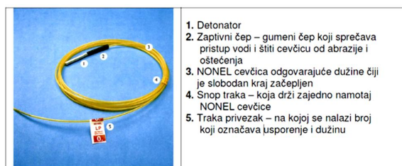
Slika 33. Izgled Nonel sistema detonatora
